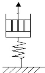
2. В представленной на рисунке механической модели, находящейся при постоянном напряжении заданы: модуль упругости  $G = 10$  кПа, вязкость  $\eta = 30$  кПа·с, напряжение  $\tau = 80$  кПа. Определить относительную деформацию  $\gamma$  через 4 с после приложения напряжения.
